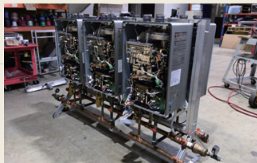
ラックシステムに設置した業務用給湯器
