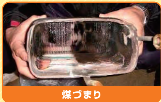
経年劣化により事故の発生した湯沸器の内部
