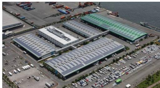
同発電所には太陽光発電モジュールを4,942枚設置。年間発電量は合計約120万kWhで、これは一般家庭の約220世帯分（関西電力㈱による従量電灯A契約のモデルケース300kWh/月の電力使用量での換算では約340世帯分）に相当します。年間600トンを超えるCO<sub>2</sub>の削減効果を見込みます。発電した電力は再生可能エネルギーの固定価格買取制度に基づき、全量を電気事業者に売電します。
